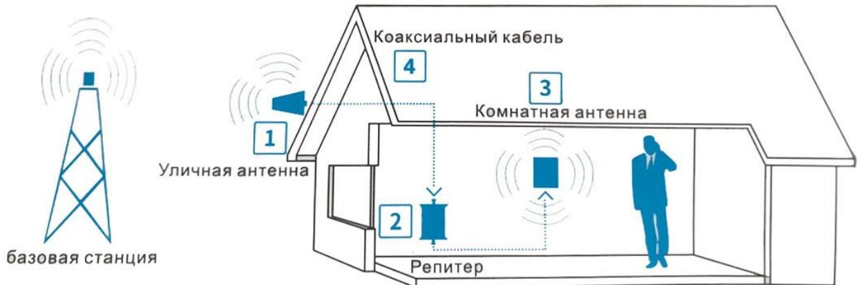
Стандартный уличный комплект усилителя связи состоит из: уличной антенны, репитера, комнатной антенны, коаксиального кабеля, адаптера и креплений к ним.
